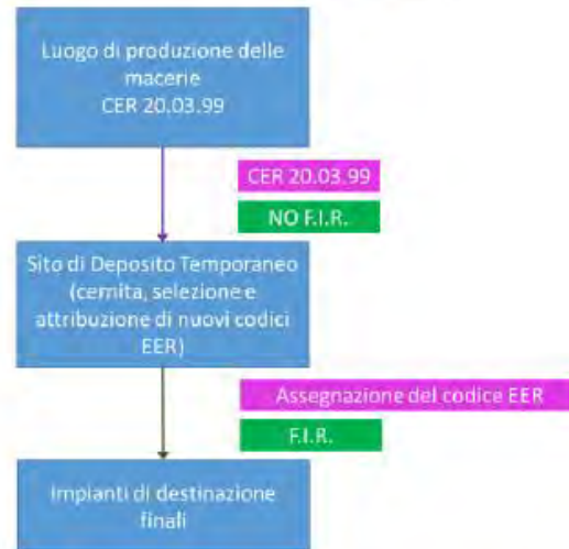
Figura 3 – Rimozione e cernita nel sito di deposito temporaneo con successivo trasporto agli impianti
