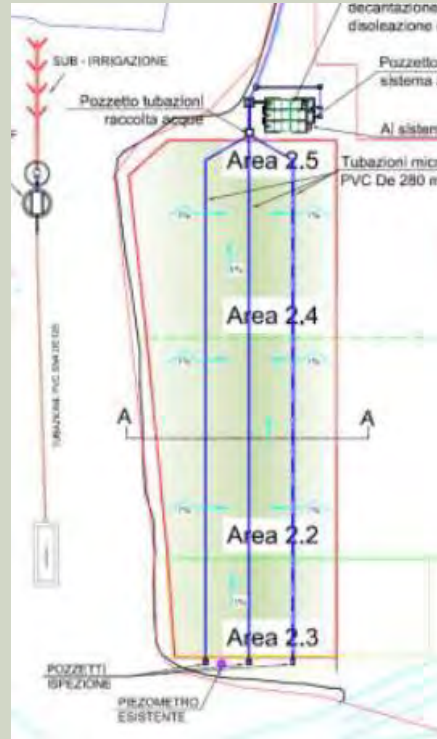
Impermeabilizzazione area deposito macerie
