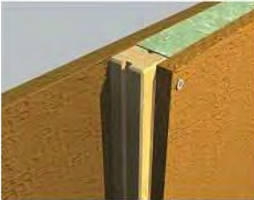
Cappotto interno in materiali ecosostenibili (pannelli di terra cruda intonaci di argilla)
