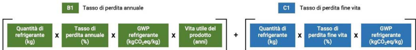
Figura 12.5 – Calcolo delle emissioni derivanti dalle perdite di gas refrigerante.
